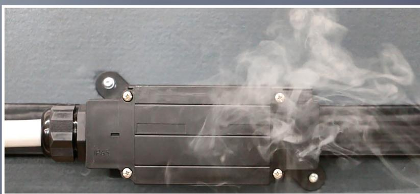
**Bild 1** Rauch bei der Anschlussdose, infolge überhitzter Kontakte
